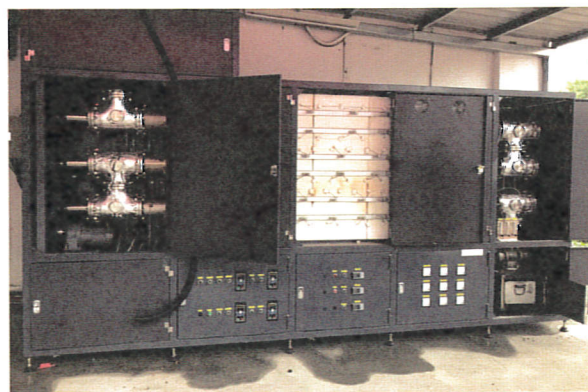
圖 3. 屏東科技大學生物炭製程示範工廠炭化爐
