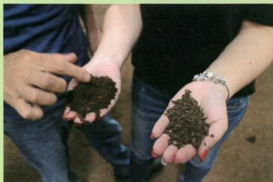
超吉公司依照肥料廠需求產出不同乾燥與顆粒程度的木屑，解決過去太空包水分含量過高的問題。
