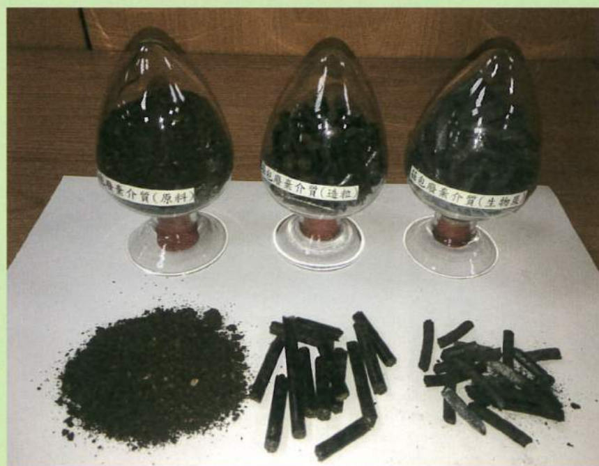
菇包廢棄介質原料（圖左）、菇包廢棄介質造粒（圖中）及其所製成的生物炭（圖右）。 （圖片提供／薛佑光）
